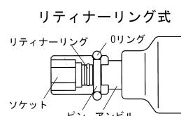
※確実に固定しないと、ソケットやビットが外れ飛び出す場合があり、大変危険です。又、ソケットやビットを付けての空転は絶対に行わないでください。
